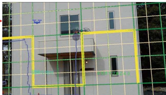
図6 外壁点検における HoloLens 内でドローンの飛行ルートを確認・操縦する様子
