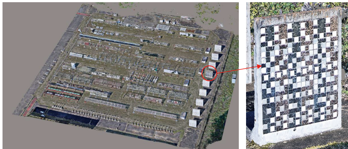
図10 上空から撮影した垂直面の3次元モデルの精度 (1億画素)
