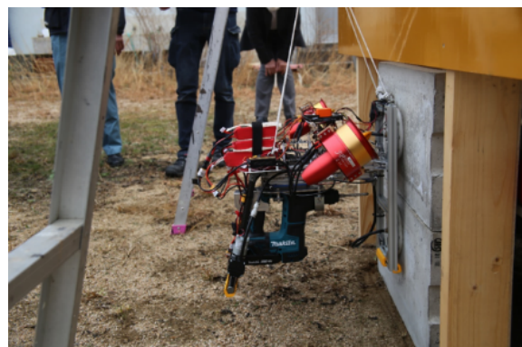
図14 子機のドリル作業実証実験
